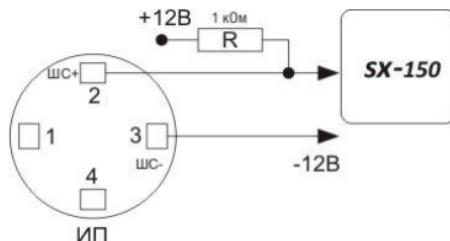
Схема подключения нескольких ИП в один шлейф
